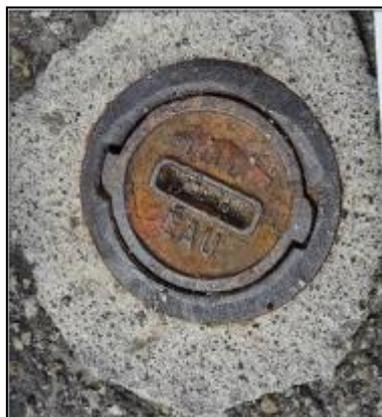
Figure 3 : Exemple de pose d'un piézomètre (phase étude géotechnique) ras de sol (source : GEOTEC).
