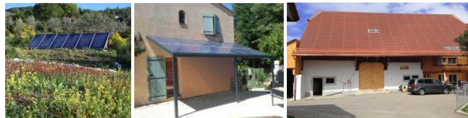
Panneaux au sol, en auvent et sur 100% d'une toiture principale et de couleur rouge
